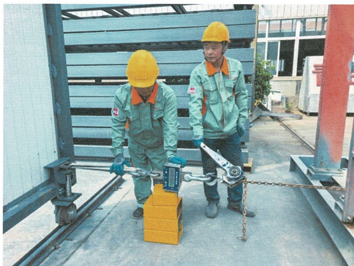
4、检测施力方式: 用5吨电子秤测力, 2吨 手动葫芦施加拉力(代替标准中的千斤顶)
